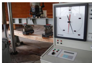
CLT曲げ強度試験状況
